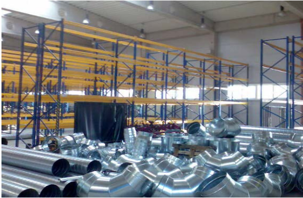
Prvky pro výstavbu centrálního potrubního rozvodu, lehké ocelové SPIRO potrubí, tvarovky s pryžovým těsněním.
