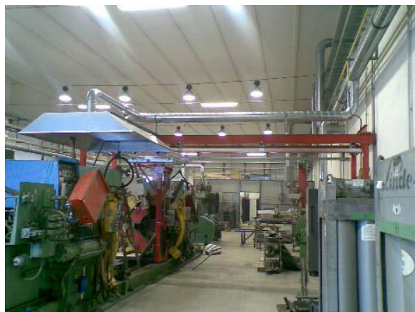
Obr. č. 2 Instalování odsávací digestoře nad robotizovaným svařovacím pracovištěm. Pohled na pracoviště.
