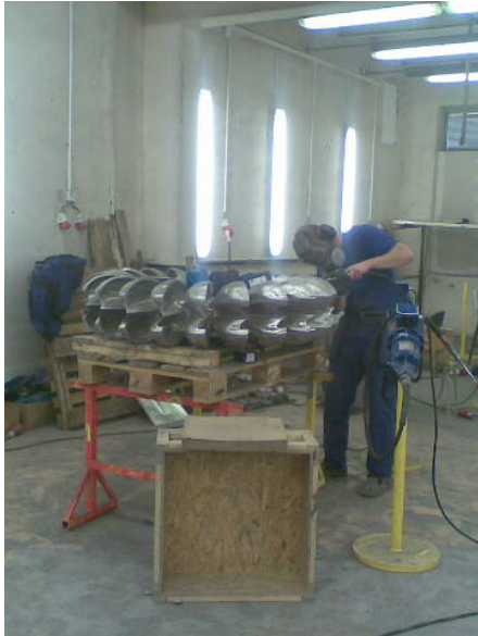
Detail brousicího pracoviště. Ruční broušení a leštění nerovností po CNC obrábění.
