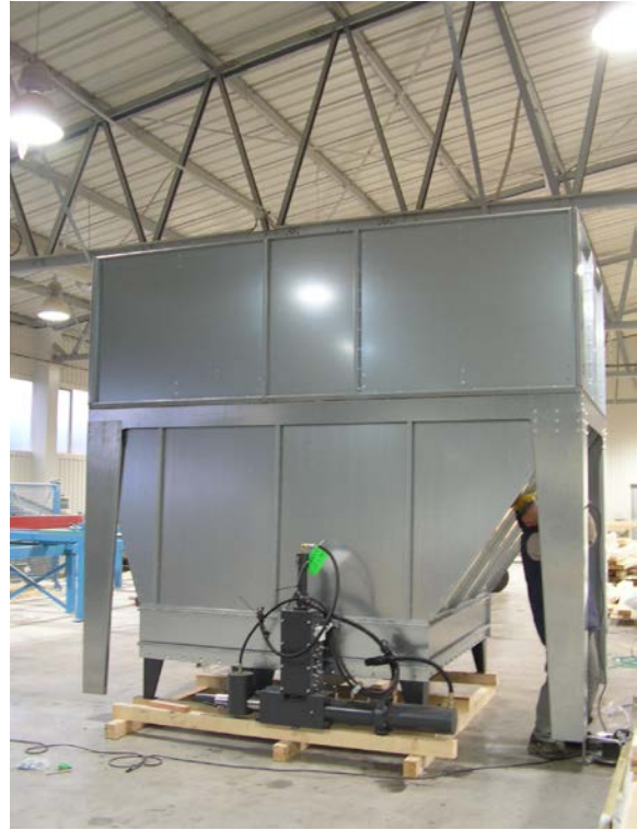
AL-KO ECO JET DUO – spodní díl s hydraulickým briketovacím lisem AL-KO APV 80. Výstupní průřez pro brikety 70 mm.
