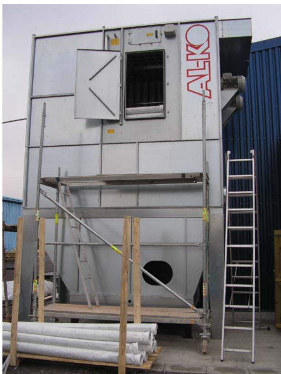
AL-KO ECO JET DUO – stavba. Na paletě jsou filtrační rukávy, které se upevňují do filtrační skříně.
