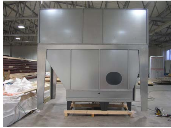
AL-KO ECO JET DUO spodní díl – detail, ve spodní části je již nainstalován hydraulický briketovač.
