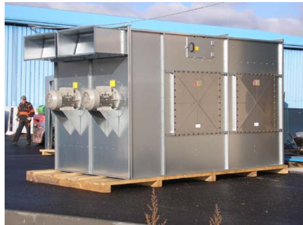
AL-KO ECO JET DUO motorový díl. Odsávací zařízení je dodáno po jednotlivých stavebních dílech, které se přímo u zákazníka staví pomocí autojeřábu.
