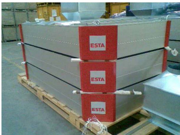
Pohled na odsávací digestoře uložené na přepravní paletě. Digestoře jsou vyrobeny z ALU materiálů.
