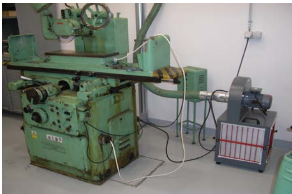
Celkový pohled na pracoviště. Bruska propojená s malým odsavačem ESTA KAF – 100 krátkou flexibilní PU hadicí.
