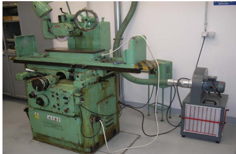
Propojení odsavače s bruskou.
