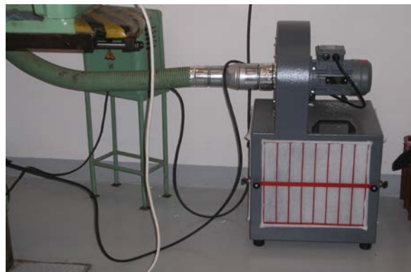
Malý odsávací modul ESTA KAF – 100. Detailní pohled na provedení odsavače. V bocích jsou vsazeny filtrační kazety.
