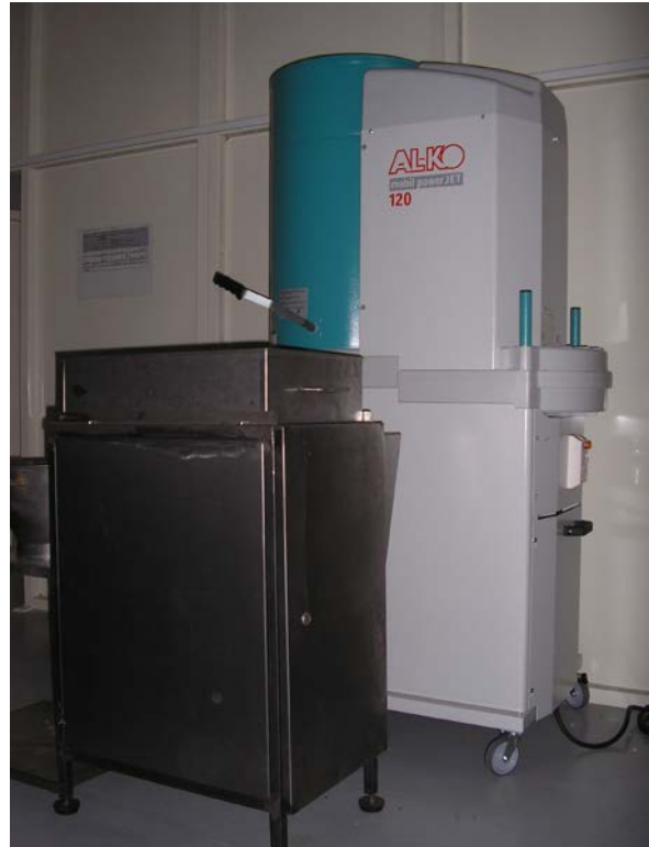
Umístění mobilního odsavače a zájmového zařízení. Výrobní prostor je díky vhodně navrženému odsávacímu stroji trvale čistý a hodnota prachové zátěže pod hygienickým limitem.
