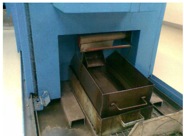
Stroj na výrobu nýtů. Detail výstupu ze stroje – místo kde se nejvíce dýmí.
