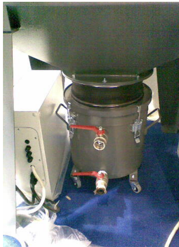
Detail sběrného zásobníku. Zásobník je hermeticky spojen s odsávacím modulem. Dva kohouty slouží k odkalování odbroušených částic.
