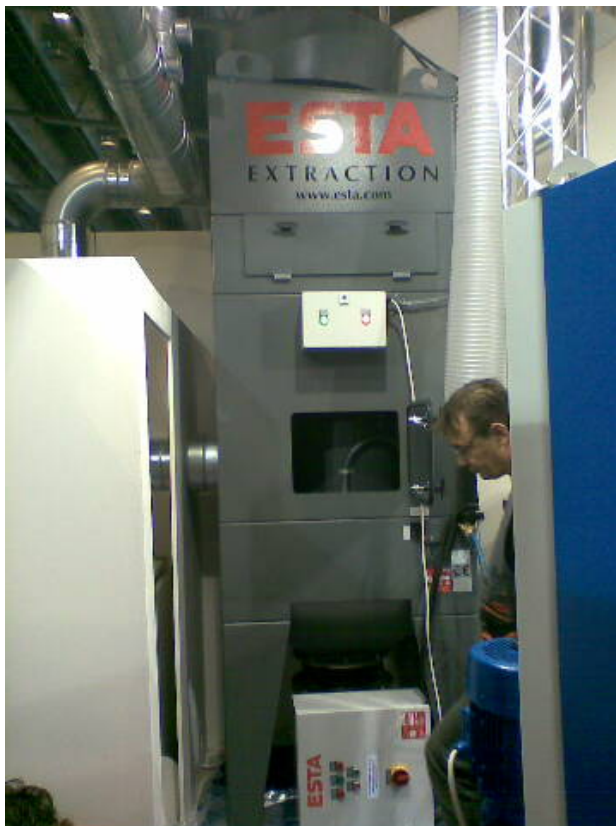
Vodní odlučovač ESTA NA-K 3600. Montáž – pohled na čelní stranu odsávací technologie.
