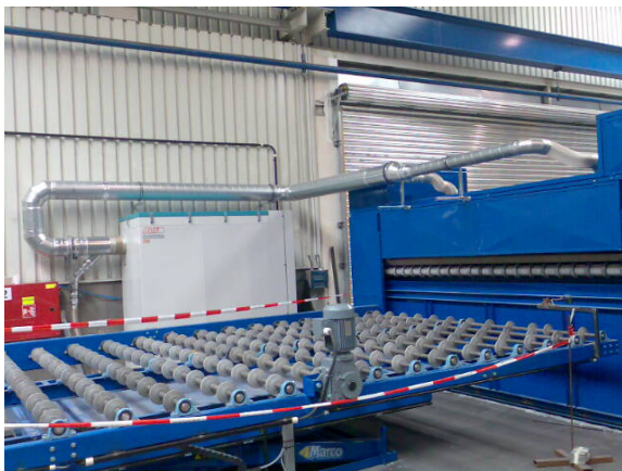
Odsávání od drtiče skla. Detail řešení (montáž).
