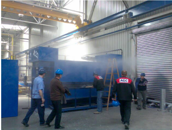
Pohled na drtič bez odsávání. Z obrázku je patrné, jak velký objem problematického prachu uniká do výrobního prostoru.
