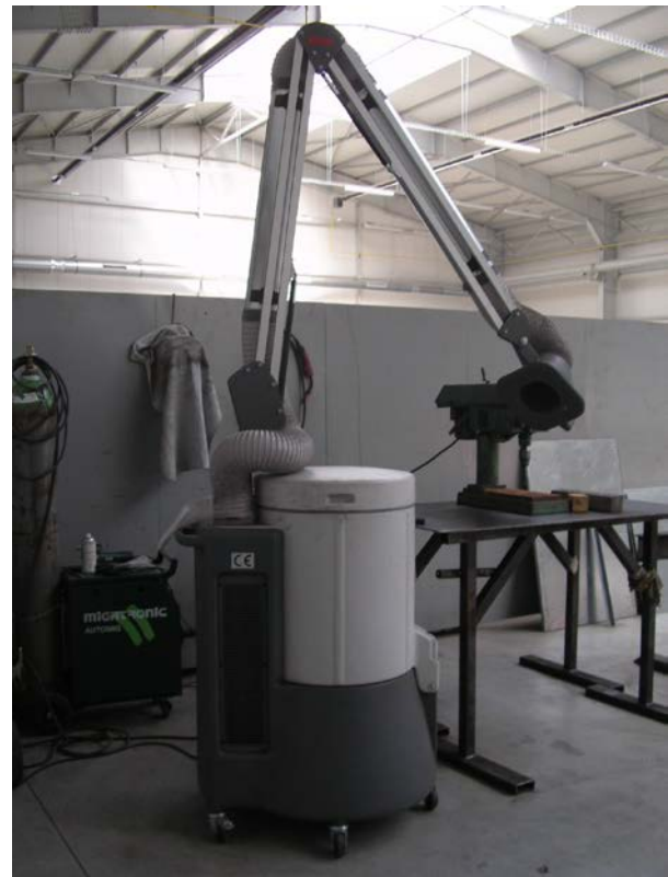
ESTA SRF K 10 na pracovišti. Celkový pohled na mobilní odsávací komplet. Odsávací rameno je přímo nainstalováno na odsávacím modulu.
