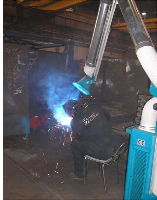
Vhodná poloha ramene umožňuje efektivně odsávat bez omezení pohybu svářeče.
