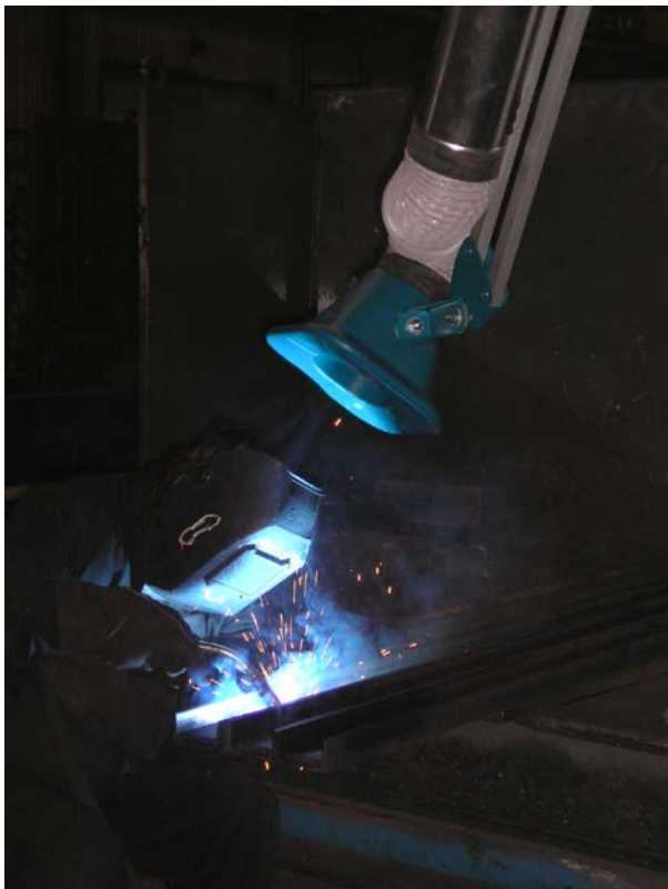
Odsávací rameno – detail polohy dymníku. Ideální poloha je cca 30 – 40 cm od zdroje dýmení.
