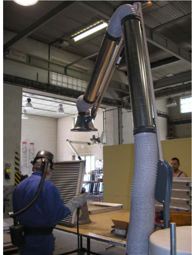
Detail ramene. Rameno je instalováno přímo na mobilní odsávací jednotce. Polohovací mechanismus je vně odsávacího tubusu, což umožňuje pohodlné dotažení ramene v případě jeho uvolnění.
