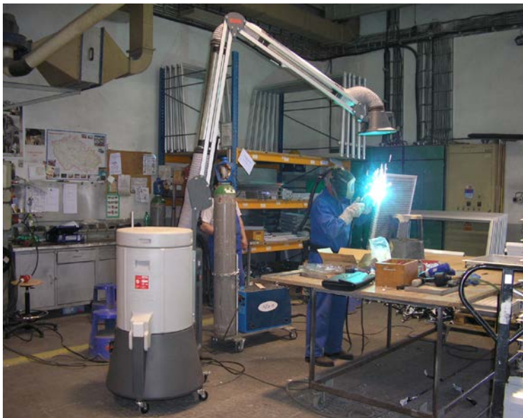
Odsávání svařovacích dýmů – detail pracoviště. Odsávací rameno s dymníkem je cca 30 cm nad svařovaným místem.
