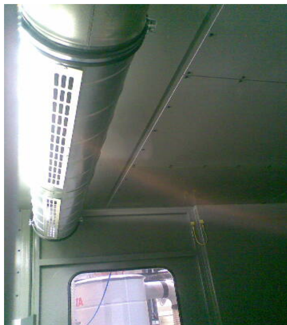
Doplnění kabiny robotizovaného obráběcího pracoviště - horní odsávací segment – detail odsávacích mřížek.
