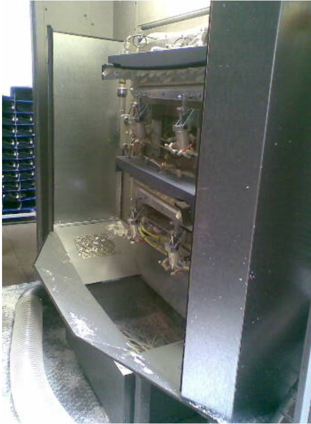
Interiér kabiny – doplnění o koncové odsávací elementy a boční plechové zábrany. Z obrázku je zřejmé nasávání odpadu přes koncové odsávací prvky.
