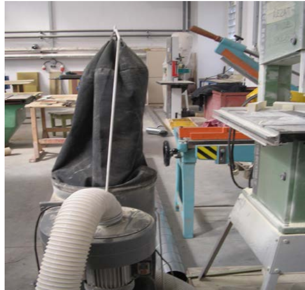
Obr. 2. Detail odsavače – pronikání prachu povrchem nevhodného filtru.
