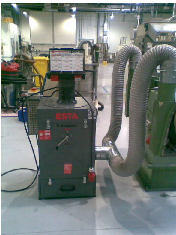
Odsávání pryžových částic. Detail dispozičního řešení pomocí malého odsávacího modulu ESTA OM – 10 a jeho propojení flexibilními hadicemi s výrobní technologií..
