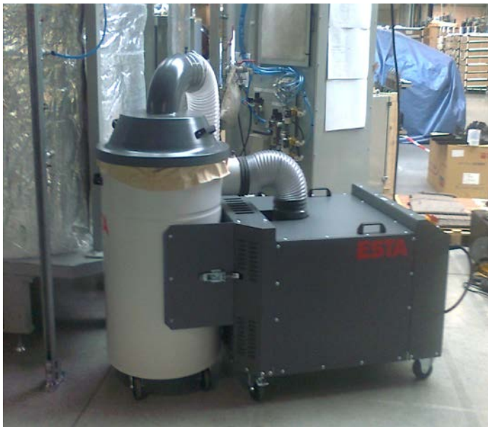
Propojení mobilního odsávacího zařízení pro lepkavé a vláknité částice ESTA DUSTOMAT 160 S pomocí krátké flexibilní hadice se zájmovým stroje.
