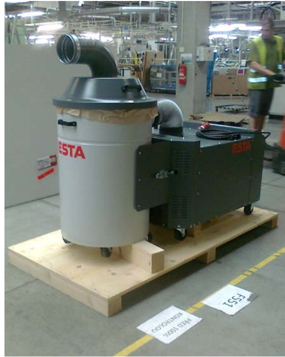
Mobilní odsavač vláknitých a lepkavých prachových částic ESTA DUSTOMAT 160 S na přepravní paletě.
