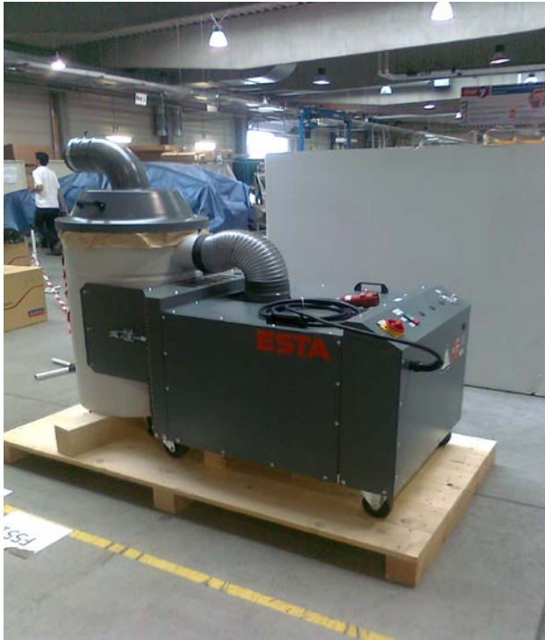
Instalace speciálně pro vláknité a lepkavé prachové částice vyvinuté odsávacího zařízení ESTA DUSTOMAT 160 S.
