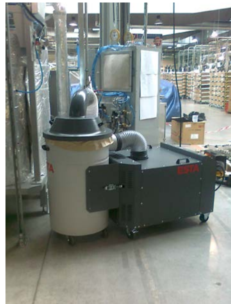
Pohled do pracovního prostoru. Odsávání textilních částic pomocí mobilního odsavače ESTA DUSTOMAT 160 S
